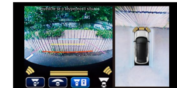
Automatické zobrazení na displeji při aktivaci předních parkovacích senzorů
