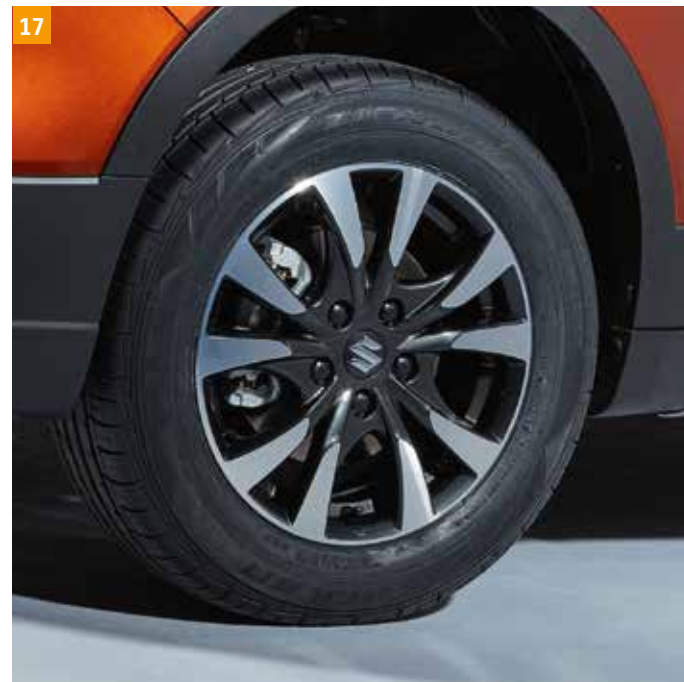
17 | RÁFEK Z LEHKÉ SLITINY „NAMIB“ 6,5 J × 16" Pro 215/60 R16, včetně středové krytky s logem Suzuki, schválení podle norem WVTA Černý leštěný Objednací číslo 43210-64R60-QC8
