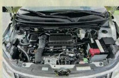
meho vstřikování benzingu, ovšem v originální podobě Dualjet, kdy na každý válec připadají dva shodné vstřikovače. Mimo jiné tak motor nepotřebuje částicový filtr. Zatím.
