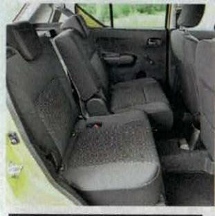
Testovaný vůz byl vzadu pouze pro dva. Obě poloviny lavice lze nezávisle posouvat o 165 mm a měnit i sklon opěradla.
