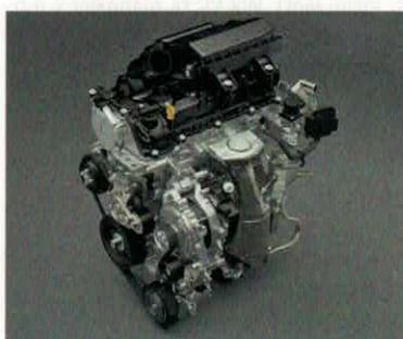
Výrazně modernizovaný motor DualJet s dvojicí vstříkovačů na každý ze čtyř válců se stále obejde bez filtru pevných částic
