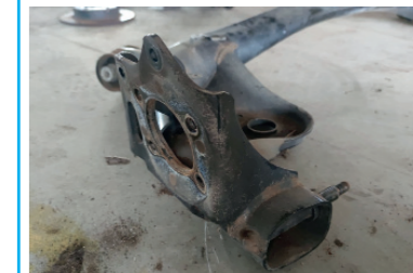
Špatné sjíždění zadních pneumatik bohužel nemá jiné řešení než výměnu celé nápravy
