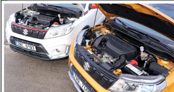
Tříválec 1.0 BoosterJet/82 kW (nalevo) nebyl špatný, ale ani o mnoho úspornější než čtrnáctistovka (napravo), která udivovala dynamikou
