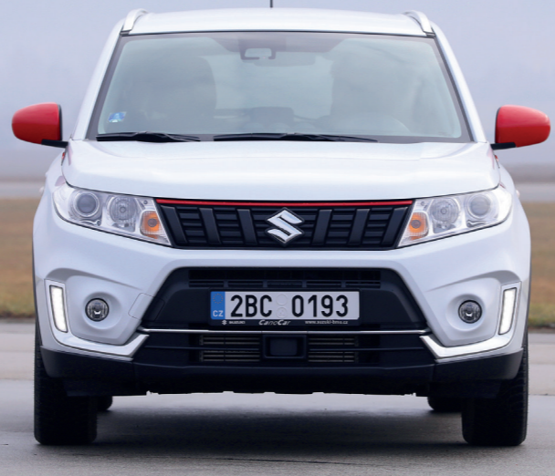
V roce 2018 se radár přesunul do spodní části nárazníku, a hlavně se stal již naprosto spolehlivým. Do faceliftu z něj tak nemusíte mít strach.
