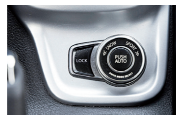
Od redukční převodovky nová vitara upustila a přešla na sofistikovanější automatický režim s manuální volbou
