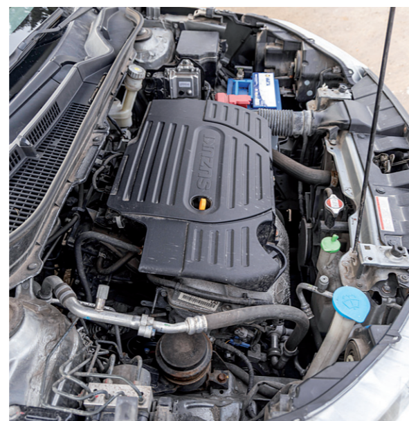
Atmosférická šestnáctistovka s označením M16A patří mezi nejspolehlivější motory. Je i celkem rozměrově kompaktní, a tak je kolem i dostatek prostoru pro ruce mechanika, i když tím nejčastějším úkonem pod kapotou bude dolit kapaliny do ostříkovačů.
