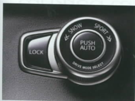
Ovladač systému pohonu 4x4 je hned vedle ruční brzdy. Disponuje čtyřmi volitelnými režimy pro zvýšení trakce.
