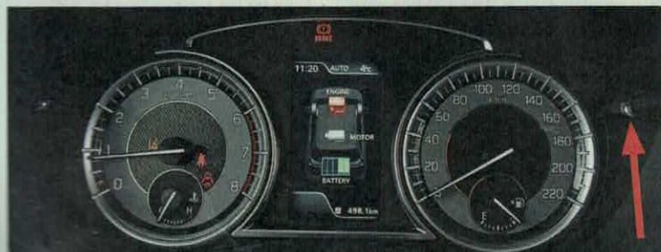
Přístroje prošly omlazovací kúrou, nadále však zůstávají analogové. Mezi nimi se usadil nový, barevný displej palubního počítače. Přepíná se nadále mačkáním kolečku, což připomíná skutečné stáří vozu představeného už v roce 2013.
