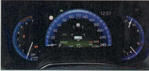
Z přístrojového štítu trčí klasický japonský kolíček. Kromě nulování denního počítadla se s ním nastavuje i jas podsvícení.
