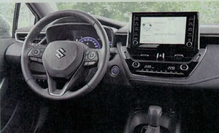
Práci hybridního systému a toky energie můžete sledovat buď v přístrojovém štítu, nebo na centrálním monitoru. Do 50 km/h spalovací motor obvykle stojí.
