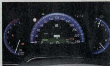
Práci hybridního systému a toky energie můžete sledovat buď v přístrojovém štítu, nebo na centrálním monitoru. Do 50 km/h spalovací motor obvykle stojí.
