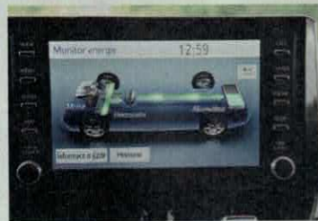
Práci hybridního systému a toky energie můžete sledovat buď v přístrojovém štítu, nebo na centrálním monitoru. Do 50 km/h spalovací motor obvykle stojí.
