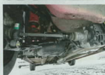
Kvůli pohonu zadních kol a diferenciálu podlahou se nádrž zmenšila na 40 litrů
