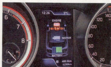
Stav baterie ukazuje displej. Maximem je pět dílků, na jeden nespadne při jízdě nikdy. Leda byste auto na dlouhou dobu odstavili, což by baterii rozhodně neprospělo.
