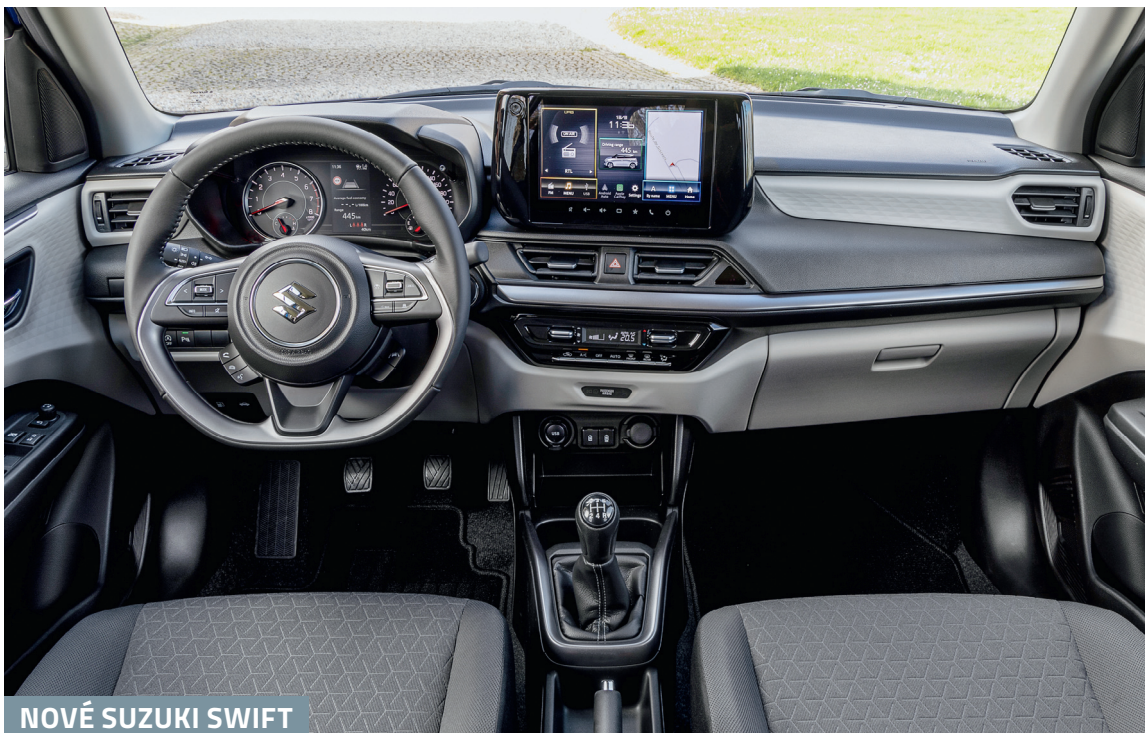
Ve středu je 9" obrazovka, zatímco před volantem najdete klasické analogové přístroje
