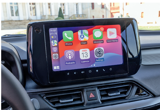
Ve středu je 9" obrazovka, zatímco před volantem najdete klasické analogové přístroje
