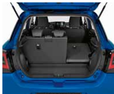
Zavazadlový prostor s objemem 295 litrů mezigeneračně narostl o 30 l a odpovídá standardům tohoto segmentu
