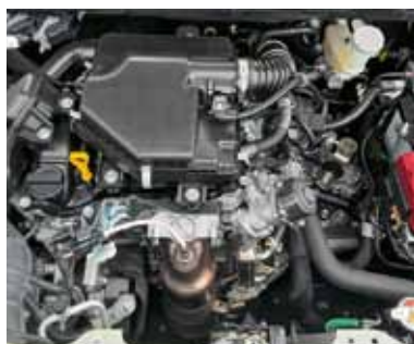
Nový motor překvapuje vysokým kompresním poměrem 13,9:1, v praxi potěší ochotou k vytáčení i nízkou spotřebou
