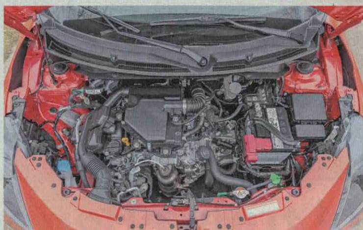
Nová tříválcová dvanáctistovka se standardně pojí s 12V mild-hybridem, který poskytuje 2,3 kW a 60 Nm
