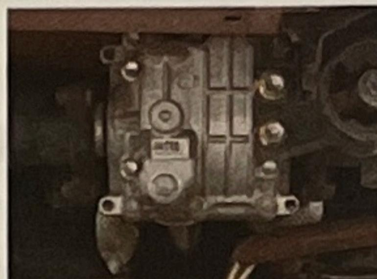
Viskózní spojka je v jednom těle se zadním diferenciálem
