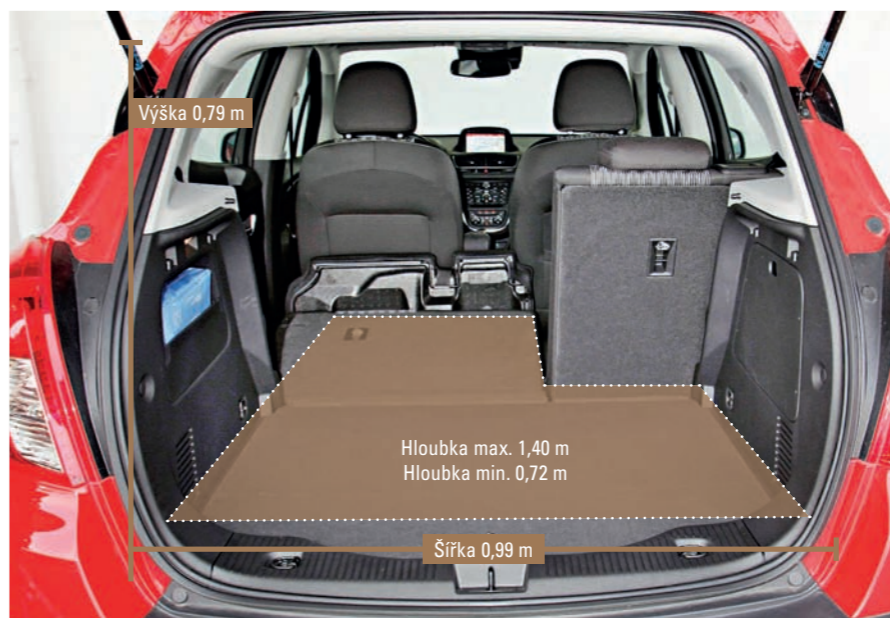
Po přiklopení sedáků k zadním opěradlům vznikne napříč dost místa pro televizor nebo kolo
