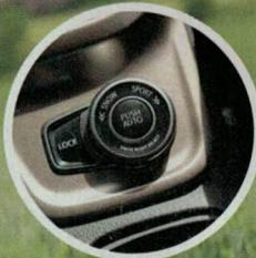
Pro jízdu v terénu se hodí asistent sjíždění z kopce i funkce Feed-forward, která vyhodnocuje přílnavost povrchu. Pokud přední kola opakovaně proklouzou, systém začne ostřejí svírat elektromagnetickou spojku. Tu je uzamknout tlačítkem Lock, kde rozděluje sílu motoru na nápravy v poměru 50:50 do rychlosti **60 km/h** nebo do chvíle, kdy snímače zaznamenají možné poškození systému.
