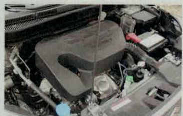
Hluk motoru do kabiny moc neproniká, pomáhá tomu instalace výfukem dopředu
