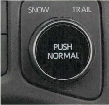
Unikátem mezi malými vozy je pohon všech kol realizovaný druhým nezávislým elektromotorem na zadní nápravě. Čtyřkolka pracuje do 70 km/h a nabízí tři režimy: univerzální, terénní a zimní, v němž aktivně rozděluje točivý moment mezi kola.
