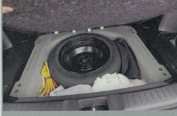
Zavazadelník má saldiný objem, pravidelný tvar, výškově stavitelnou podlžku a ve dně vanu, do níž si můžete pořídit náhradní kolo
