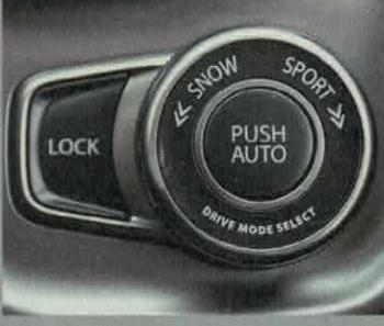
Inteligentní pohon 4x4 s elektromagneticky ovládanou lamelovou spojkou nabízí čtyři jízdní režimy. Sportovní preferuje pohon všech kol, Snow aktivně rozděluje točivý moment, Lock trvale sepné spojku až do 60 km/h a Auto se hodí na každý den.
