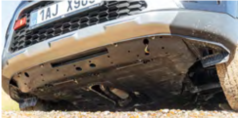
Ani u vitary není kryt motoru příliš bytelný, v běžných podmínkách stačí
