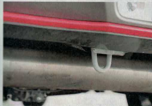
Tažné oka jsou vpředu i vzadu napevno v karoserii. Při zapadnutí nemusíte zkrhlými prsty vyloupávat krytku, v autě hledat oko a půl hodiny přičíházat na to, že má opačný závít.
