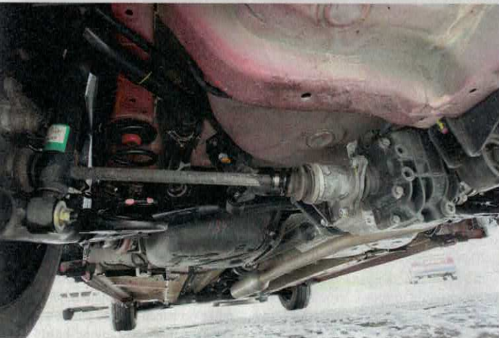
Vzácně lze narazit i na čtyřkolku. Zadní kola připojuje jednoduchá viskózní spojka.
