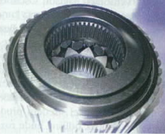
▲ Diferenciál s omezeným prokluzem, tedy verze u vozů do roku 2008, případně bez ESP.
