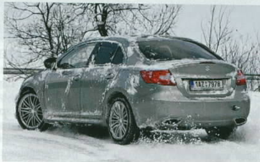
▲ Na rozdíl od pohonu SX-4 nečeká ten v Kizashi na prokluz předních kol, nýbrž tzv. předvídá adhezi.
