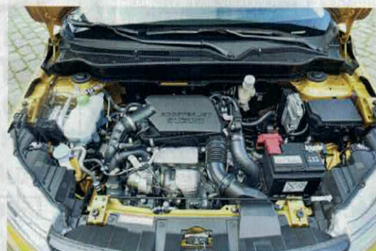
Srdcem hybridního systému je vedle spalovací jednotky také startér-generátor v podobě malého elektromotoru
