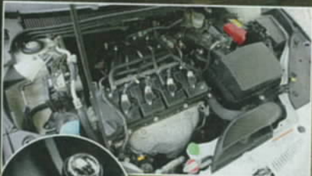
Atmosférický čtyřválec s objemem 2,4 litru spolupracuje se šestistupňovým manuálem
