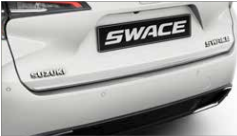
2 | Obložení pátých dveří (chromované) WVTA Vyrobeno z ABS Objednáací číslo 99002-54Z00-008 A
